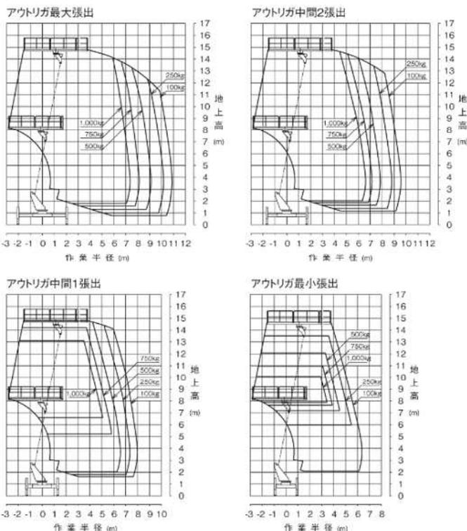
※アウトリガ一張出幅と積載荷重によって、作業範囲が規制されます。
