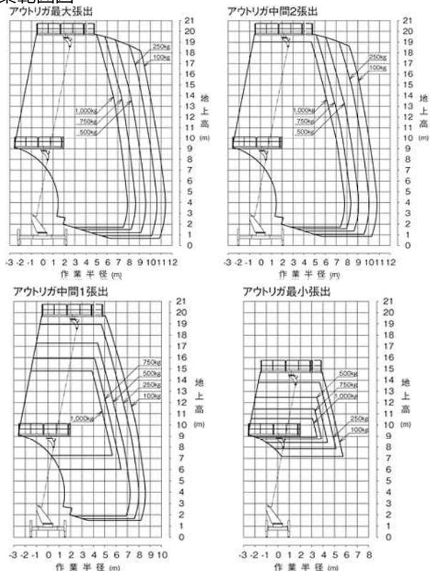
※アウトリガー張出幅と積載荷重によって、作業範囲が規制されます。
