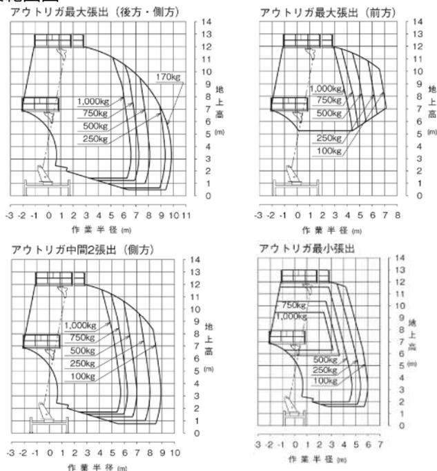
※アウトリガ一張出幅と積載荷重によって、作業範囲が規制されます。
